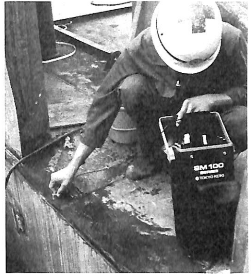
主甲板ブロック・ジョイント部のクラッチ有無の計測 (船主及び船級協会サーベイヤー立合いの下に)
