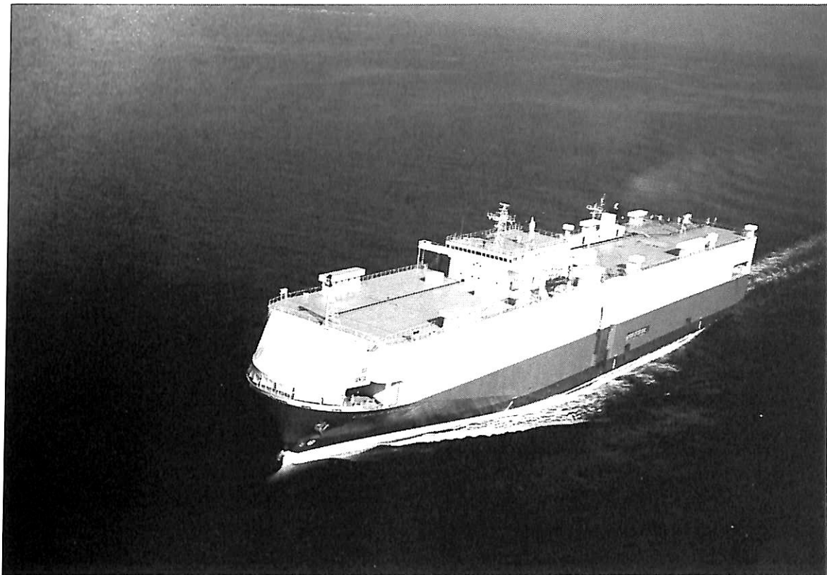
デッキ前方に風圧抵抗の減少を計るための濱田式導風膜 ART (Air Resistance Reduction Tent) を施した本船。パイプ構成のフレーム構造体にポリエステル製の膜材を取り付けたものである。(写真下は ART 取付け前の本船)
