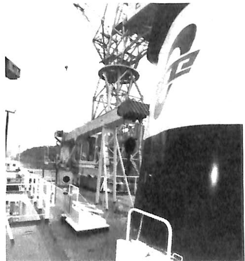
ガーベージ専用 5 t テレスコ型デッキクレーン
