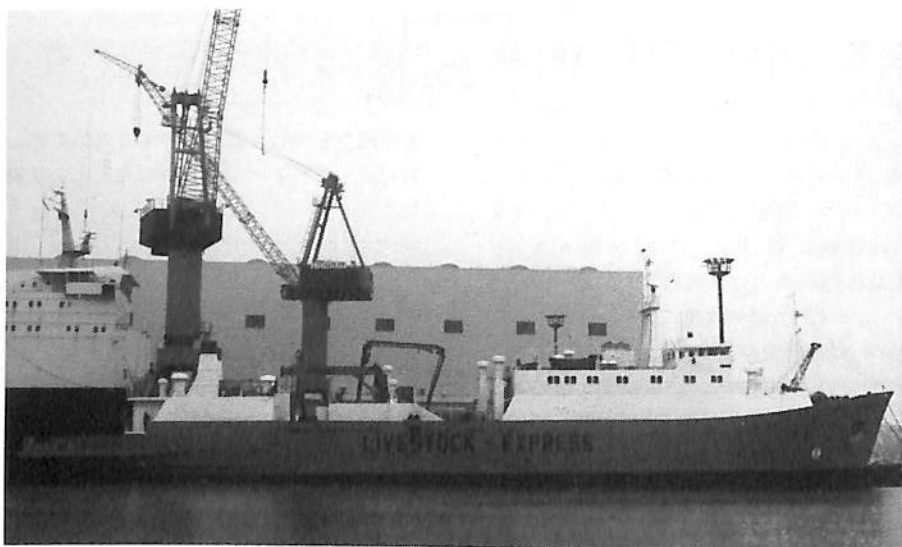
西独の Meyer Werft Papenburg W. G. で家畜運搬船 (牛650頭収容)を改造建造
