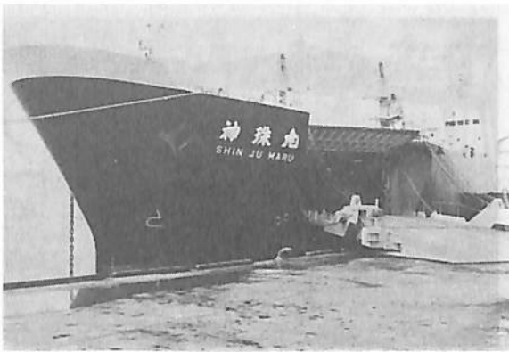
船首ランプウエータイトドアがはね上って開いているのが見える。
