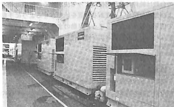
▲10基の Cummins/petbowディーゼル発電装置のうち3基がスラストに給電する。MK IIIおよびMK IVの両設計とも同じ台数の装置を持つが旅客収容能力が両設計で異なっているのでそれらの暴露甲板上の位置が異なっている。
