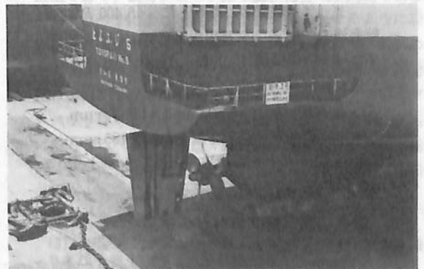
写真 “とよふじ5” に取付けられた二重反転プロペラ
