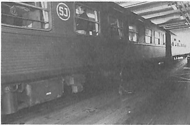
◀写真3 デンマークの鉄道連絡船上でチェーンにより船体に固定されたS J (スウェーデン国鉄)の一等車
