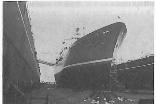
第10図 運輸省および日本海事協会の検査にも合格し船底・外舷部の塗装を終えたところ(7月10日)
