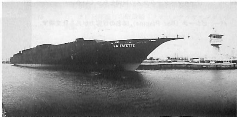
進水直後の本船を水平方向から見る。▶ クリッパー型船首構造が良くわかる。
