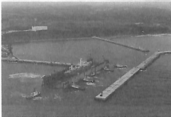
第7図 原子力船「むつ」を上架した浮ドック「さがみ」(長さ250m, 横幅52m)が関根浜港の港口(幅130m)を曳航されて通過、入港する様子。
