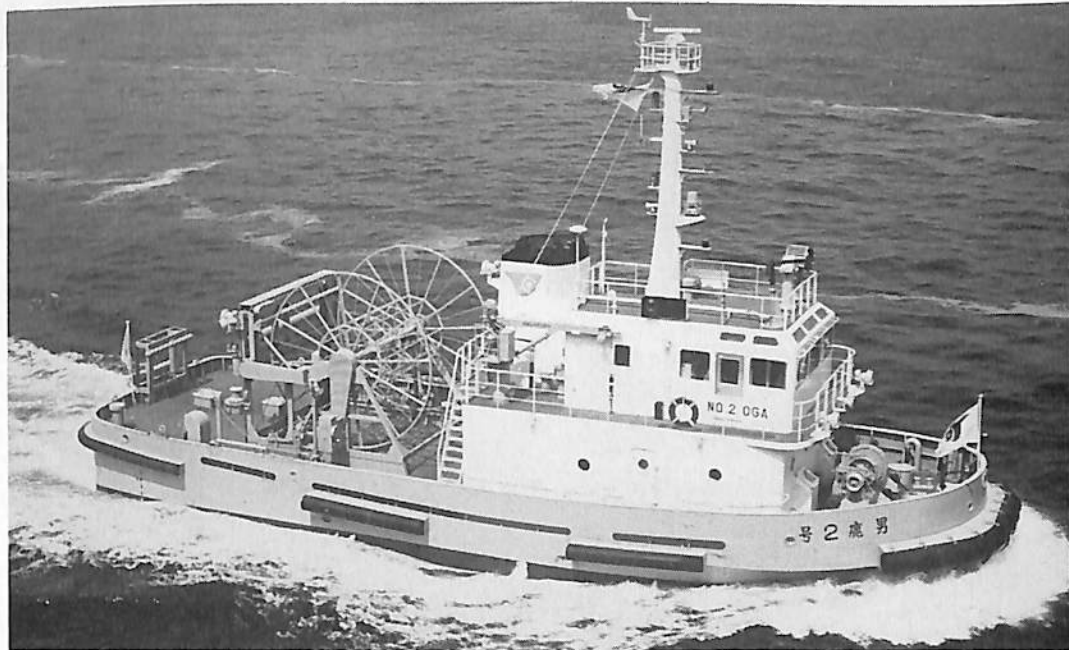
オイルフェンス展開船 鹿男 2号 秋田石油備蓄株式会社
