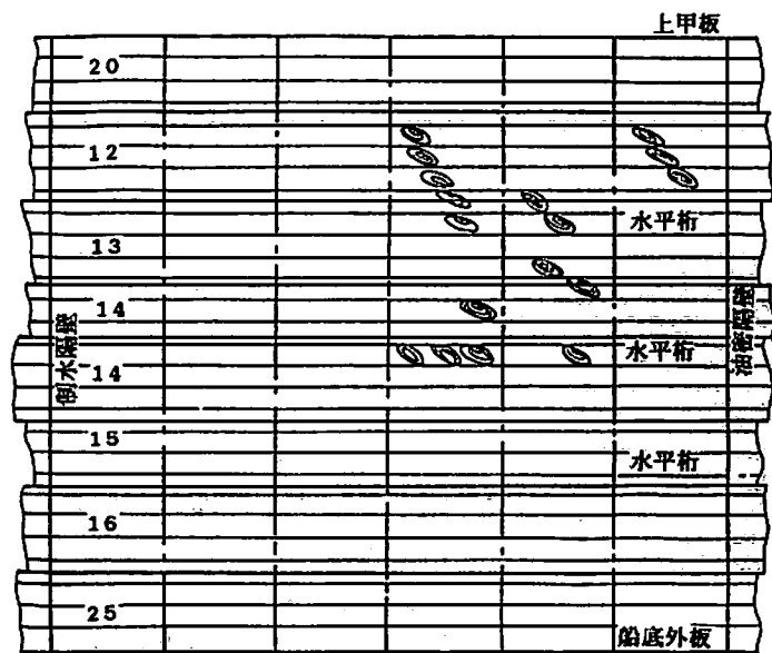
Fig 14.1 剪断による縦通隔壁の座屈例 ウズは座屈を示す (5~20mm凸出)
