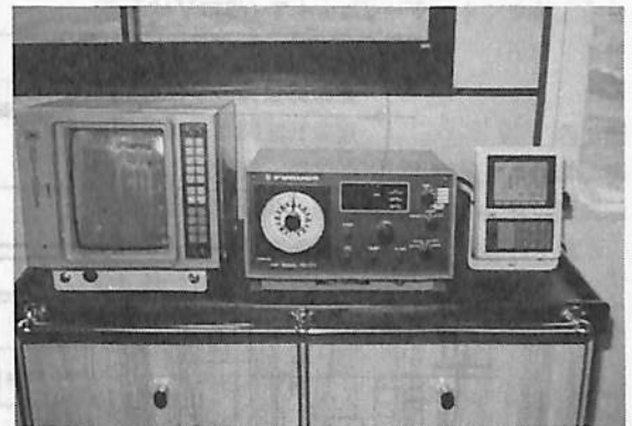
▲ 航海計器類 左よりエコーサウンダー無線方位測定機およびオートロラン受信機
