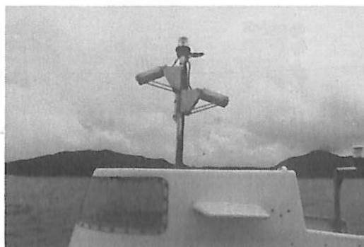
◀ 監視用ビデオ：浮上・潜水時における周囲の状況、ハッチの開閉の状況などを監視する。
