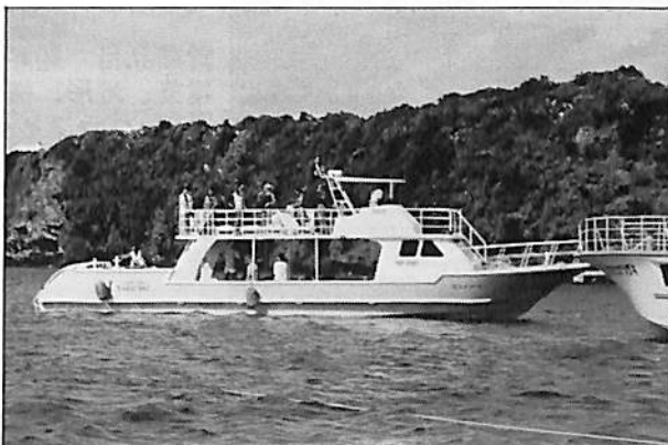
▲ DJ-100H型×2基 1990年6月 西表島就航 "ピンク ブービーII" 船主：ダイビングチーム うなりざき 主機：ヤンマーディーゼル 4CX-ET 250HP
