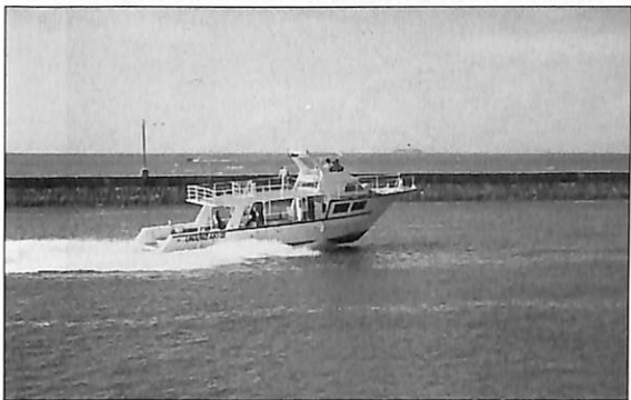
1990年8月就航“ミスウナリザキIII” DJ-130型×2基(主機350HP×2) DJ-100H型×1基(主機250HP×1)
