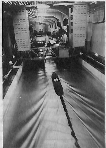
写真 7・1 波紋撮影試験の状況 (東大水槽)
