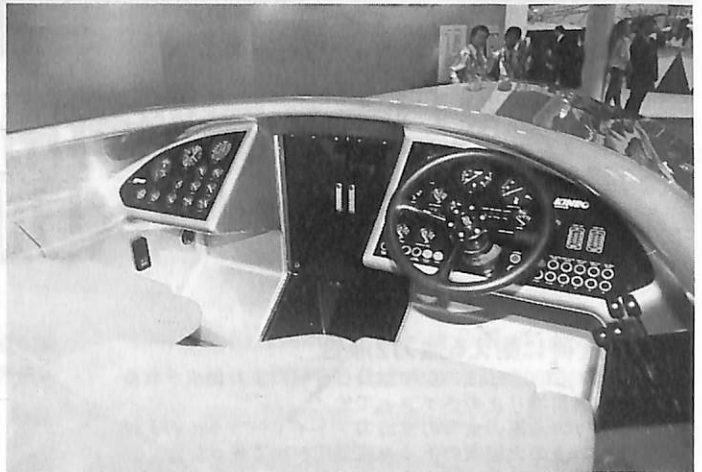
▲ コックピット (左) の計器類はナビゲーター関係 (右) は操縦関係で中央の扉内はキャビンで移動式ベッドがある。
