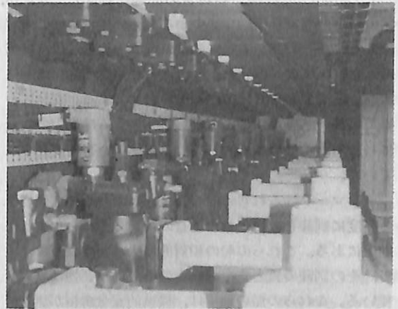
第7図 27区画を9種の温度範囲に制御する冷凍装置
