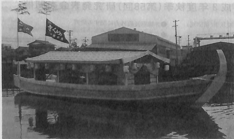
▲ 完成した“さくら丸”(長さ17.4m/幅4.1m/深さ1.1m)
