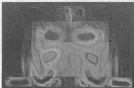
写真10・6 One-Box-Car 後方断面での縦渦等高線
