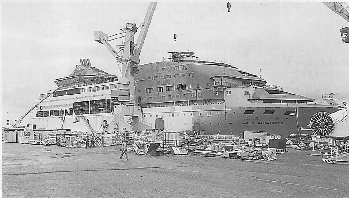
▲ フィンヤード社ラウス造船所で建造中の本船、一見小型に見えるが25,000GTある。特に船尾部が大変特徴的な型を呈しており、変形トランザム型になっている。
