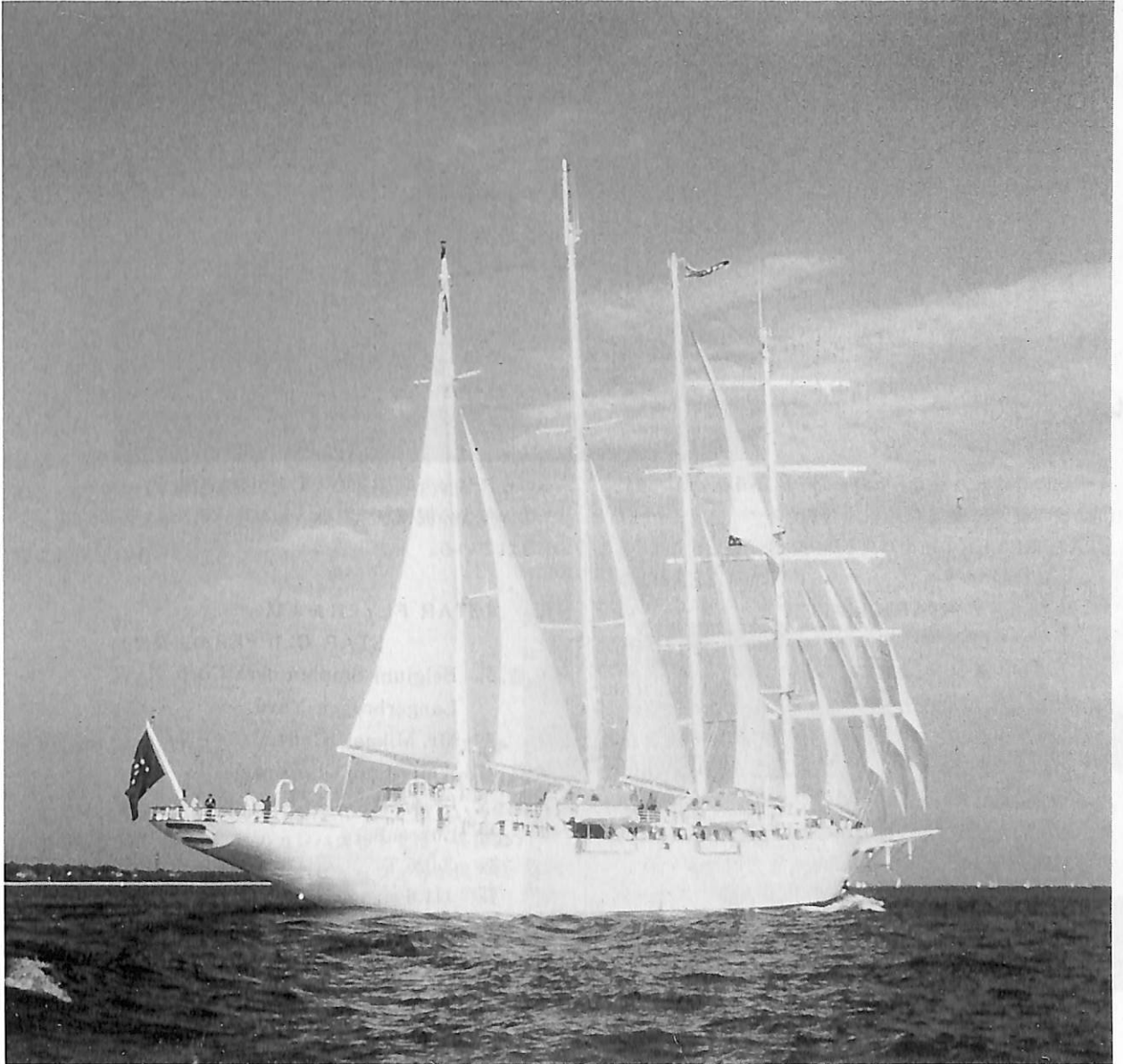
▲ STAR FLYER (総トン数 3,025 T / 載貨重量 650 t / 総帆面積 12,000 平方メートル / 帆数 17 枚 / 船客 180 名)
