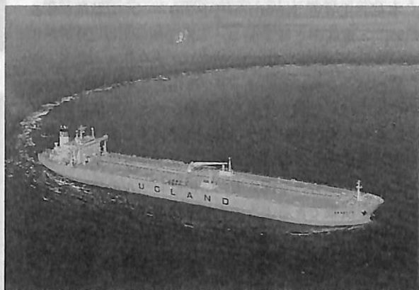
▲ 常石造船建造第一番船の二重底・二重船側付タンカー“AKARITA”
