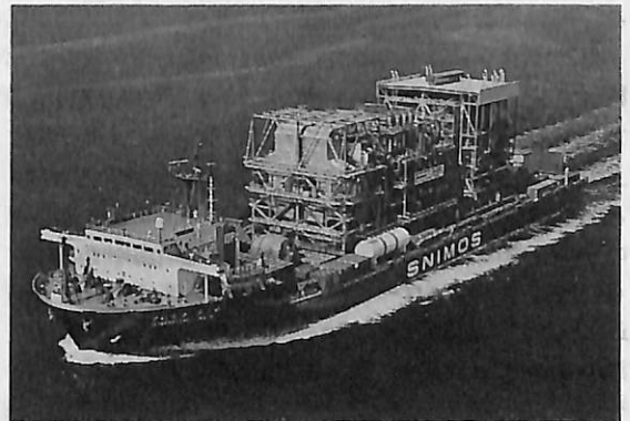
▲ 大型ボイラ・モジュールを輸送中の“すにもす えーす”
