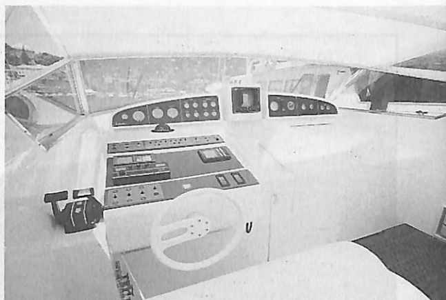
2. コックピットはシンプルなイタリアンデザイン、このコアンダ54でも判るよう、イタリア艇はポート側に操舵席の位置するものが多い。ライトアップは取外し可能となっている。
