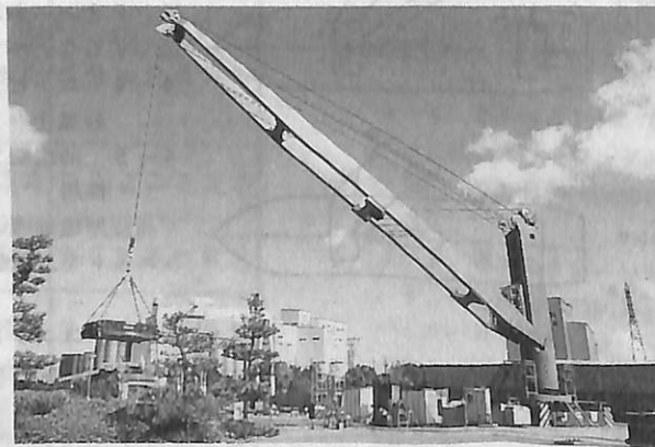
▲ 鹿島工場で公開されたスリム型L-2デッキ・クレーン
