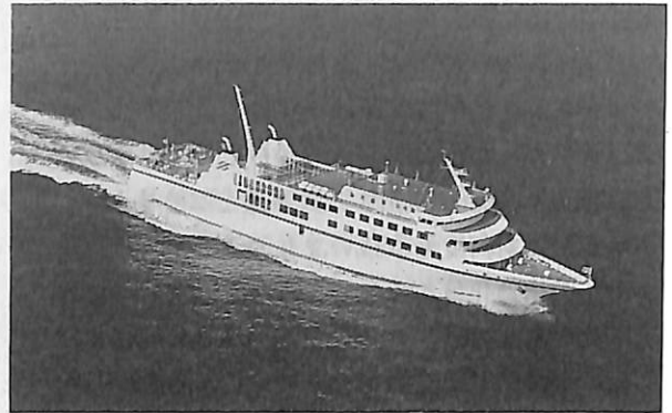
▲ 幅広高速船、ハイブリッド双船尾型の カーフェリー “太 古”
