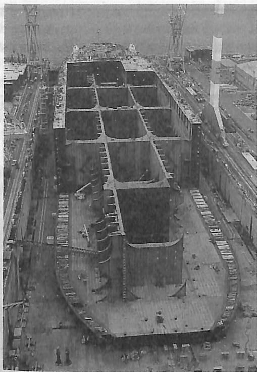
▲ 建造中の本船，ダブルハルのようすがわかる 船級 ABS, +A1, ⓐ, "Oil Carrier", +AMS, +ACCU, "VCS", "DLA"
