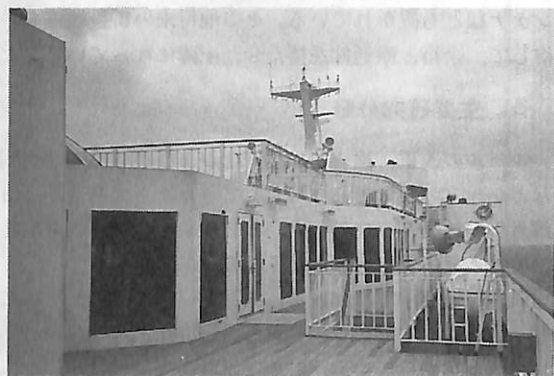
▲A甲板のイベントホール外観、窓の多さと大きさが目立つ、遊歩甲板が木甲板になっている、手すりも木だ。
