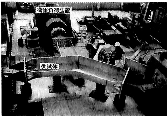
▲ 8 双胴連結部の疲労強度試験
