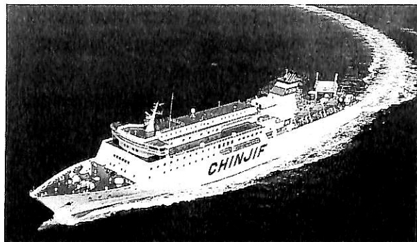
▲ 40ftコンテナを主体として載貨能力の150%アップを達成した“新 鑒 真”
