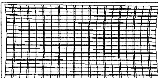
▲ 図6 格子状加熱による板の縮み
