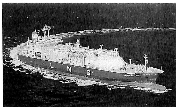
▲モス方式としては世界初の3タンク方式のLNG船“SURYA AKI”
