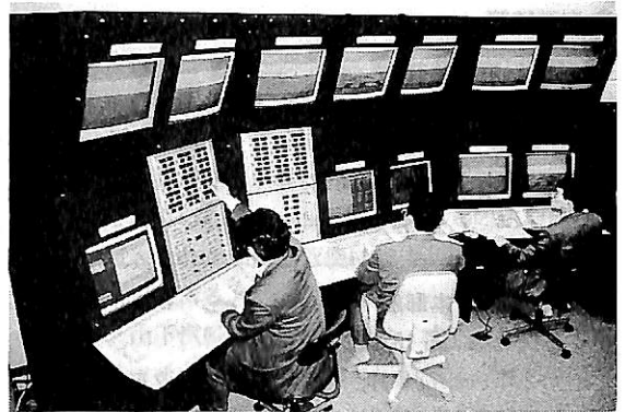
▲ 図 12 シミュレータ制御コンソール
