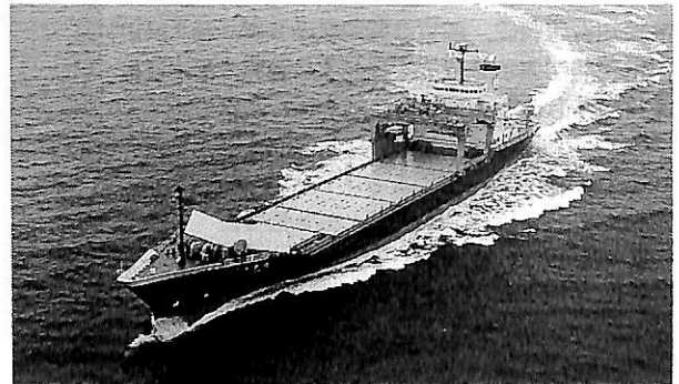
▲ ガントリークレーンの荷役能力の高速化と航海速力を 20.6 ノットとした「うらが丸」
