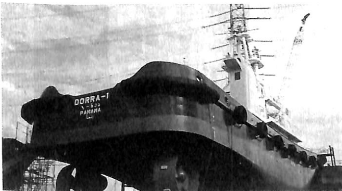
▲ 船尾、可変ピッチプロペラ旋回角度 360 度
