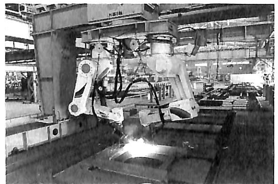
▲ 図9 ツイントーチ溶接状況
