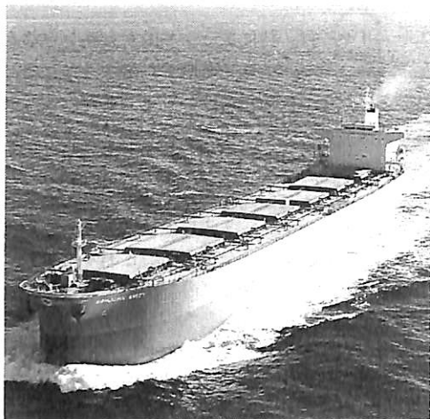
▲ "SAMJOHN AMITY" 1月NKK津造船所で竣工 全長 225.0 m / 船幅 21.70 m / 型深 19.0 m / 74,744 DWT / 貨物艙 87,667 m 3 ハッチカバー MacGREGOR
