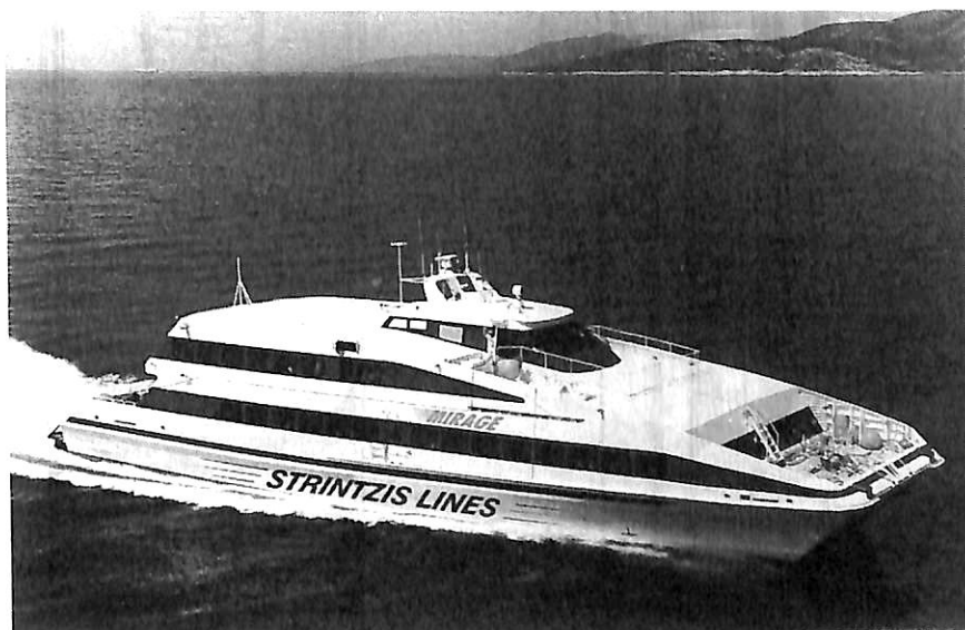
▲ 4200型“MIRAGE” 全長 42.00 m / 計画垂線長 37.37 m / 型幅 10.00 m / 型深 4.07 m / 喫水 1.88 m / 乗客 386名 /
