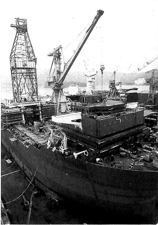
▲ブリッジ搭載中の本船、左方に高さ70ftの掘削用デリックが見える。
