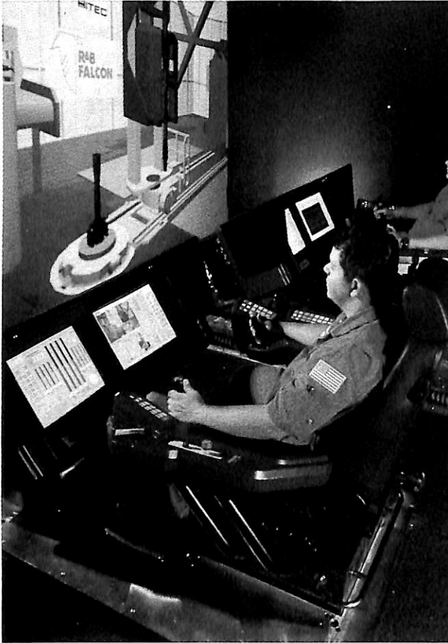
▲陸上の掘削作業リモコンシミュレータ、本船上のものレプリカ
