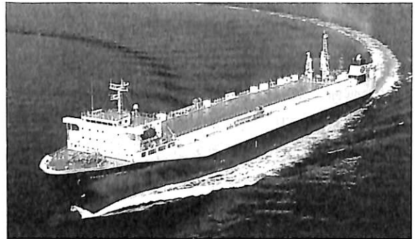
▲ 6層の自動車甲板 (リフトブルデッキ1層を含む) と最上層甲板にコンテナ積載設備を有する多目的船
