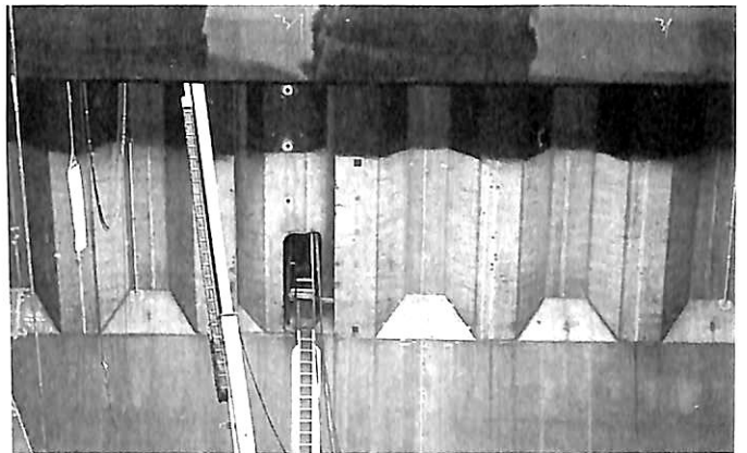
▲ カーゴホールド内：スパイラルラダー部分は囲いをして鉍石重量による損傷、鉍石溜りを防いでいる
