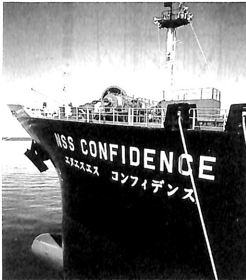
▲ 船首部側面にユニバーサルチョックを採用 係船索に対する損傷の軽減を計っている
