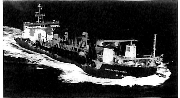
▲ 浚渫土砂を16ノットの高速運搬する “QUEEN OF PENTA-OCEAN”
