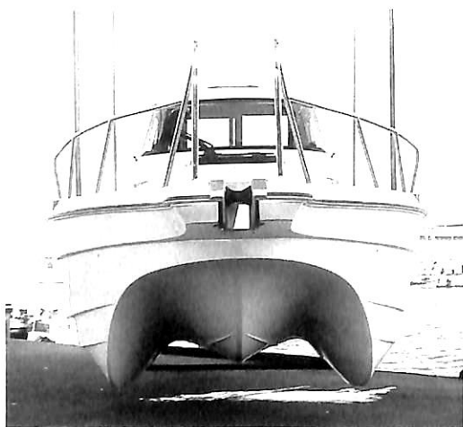
▲ベストバランスを達成したセミトリマラン船型
