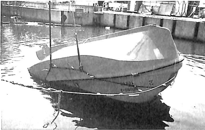
▲写真3 浸水時転覆状態からの復原性試験
