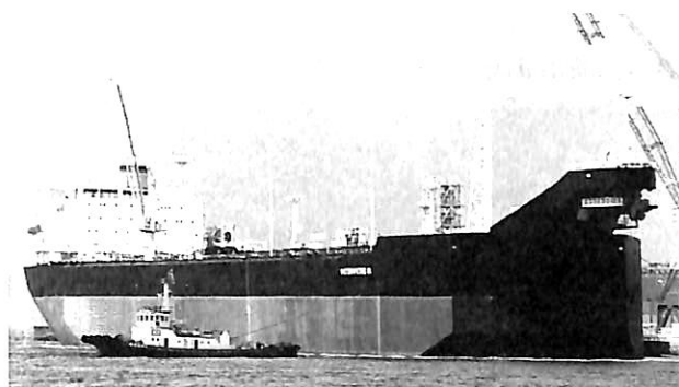
▲ “VIETSOVPETRO” 船首の突出部はタレットで ここからパイプを通し原油が取り込まれる
