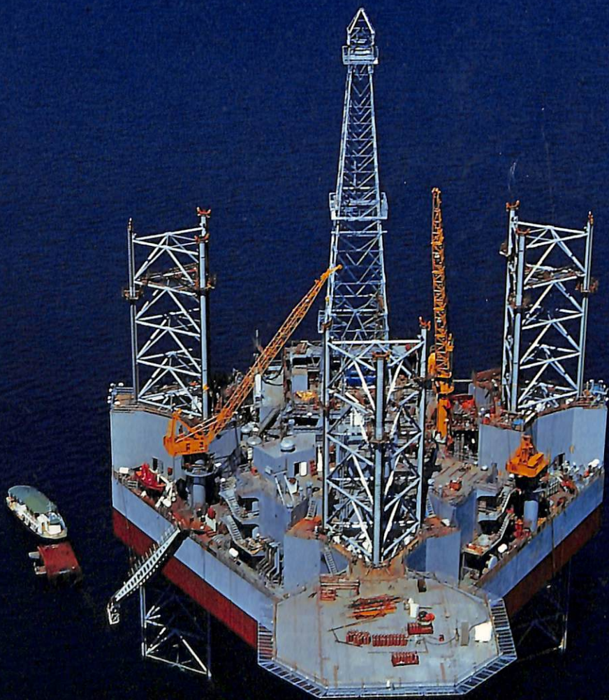
艤装中のジャッキアップ式海底油田掘削装置
