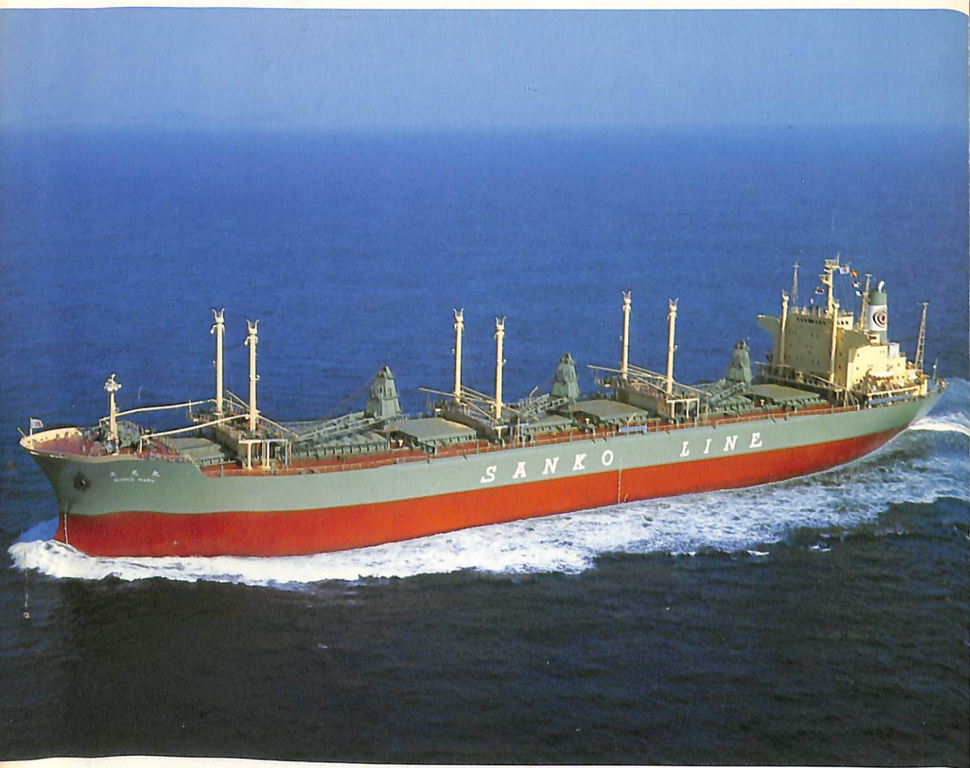
堺工場で建造されたHI-BULKシリーズ第1船“文光丸”(51,672DWT)
