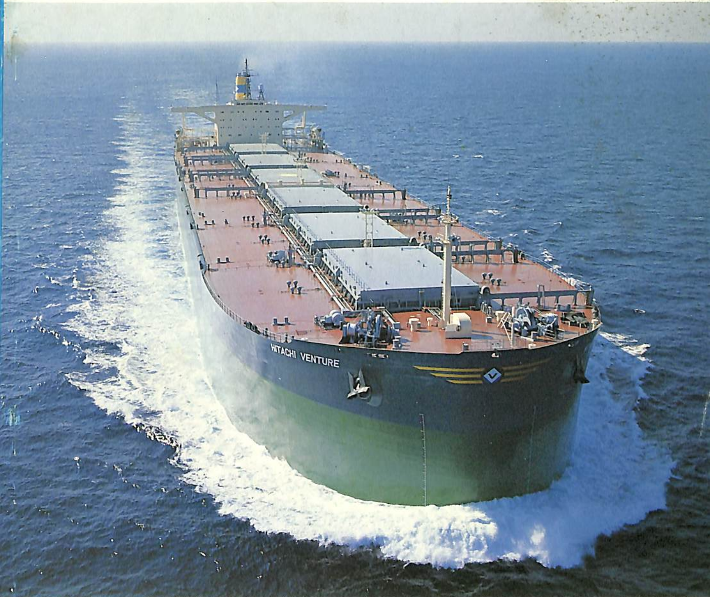
有明工場で竣工した世界最大の鉱石船 “HITACHI VENTURE” (26万DWT)
