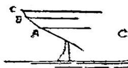
B C邊の傾斜せる香取丸級の船尾
