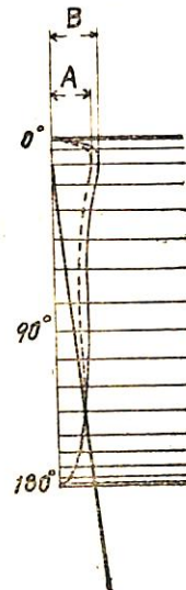
第13圖 指壓線圖 破線は無過給時正味平均壓力 P_{mo} = 5.6 kg/cm 2 、實線は50%過給時 P_{mo} = 8.5 kg/cm 2 を示す (D=370 mm H=530 mm n=320 r.p.m. の例)
