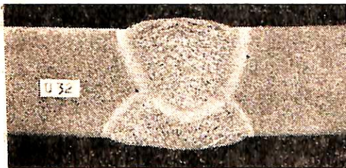
第24圖 造船用キルド鋼 (板厚 32mm) の多電極自動溶接々手 (並列方式) 肉眼組織 上層は Tandem Position 下層は Transverse Position
