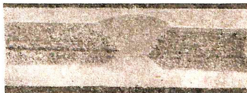
第6圖 サルファー・クラックの發生したリムド鋼、自動溶接接手のサルフェープリント)
