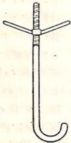
第4圖 Hook bolt for securing patches
