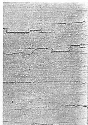
第66図 鍛鋼製水胴の内面に発生した腐蝕疲労亀裂
