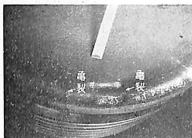
第5図 中型ディーゼルピストン頂部の周囲縁部に発生した亀裂
