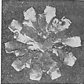
第37図 スプライン溝の事故の一例
