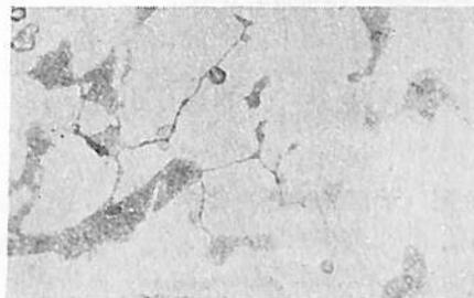
第64図 アルカリ脆性による Intercrystalline crack
