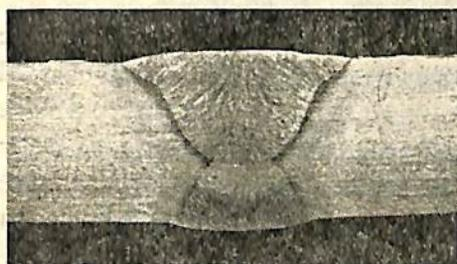
第1図 ユニオンメルト熔着鋼のマクロ写真
