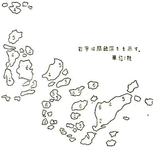
第4図 胴板水側の腐蝕の一例
