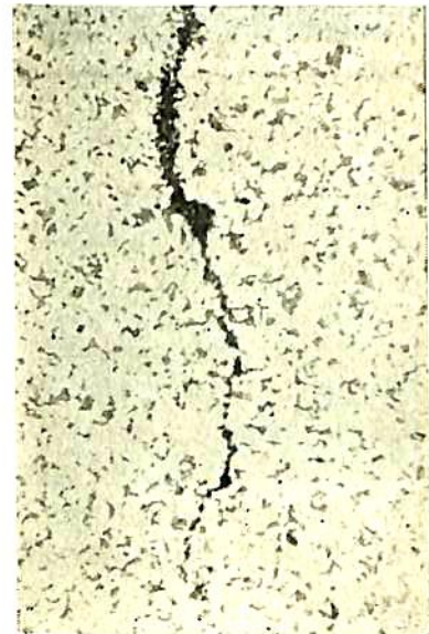
第21図 亀裂の進行状況を示す顕微鏡写真(×100)
