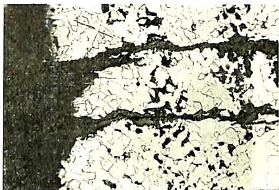
第9図 亀裂の顕微鏡写真 (×100)
