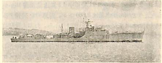
写真10. 英国対潜二等フリゲート, Murray, ハーディー (Hardy) 型に属する。基準排水量1,300トン、タービン機関、1軸、15,000馬力、速力約24ノット。米国の Dealey 型に対応する Ocean Escort. (Official Admiralty Photograph)
