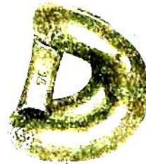
写真10 曲げ試験による鎖環の形状
